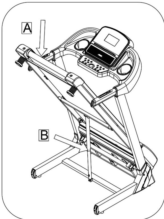
Слегка надавите одной рукой от себя на беговое полотно (A), надавите ногой на цилиндр с пневматической пружиной (B). Беговое полотно самостоятельно примет горизонтальное положение.
