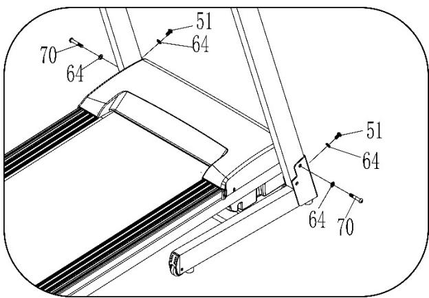
Зафиксируйте правую стойку консоли на основной раме болтами (70, 51) и шайбой(64).Затем закрепите левую стойку.
