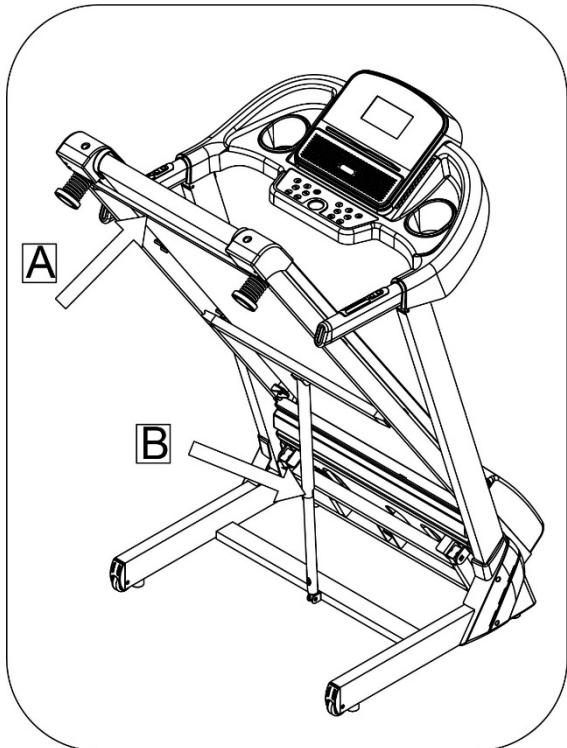
Поднимите беговое полотно в положение (A), пока не сработает фиксатор на цилиндре с пневматической пружиной (B).
