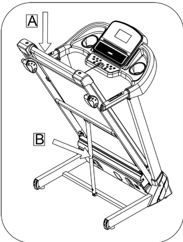
Слегка надавите одной рукой от себя на беговое полотно (А), надавите ногой на цилиндр с пневматической пружиной (В). Беговое полотно самостоятельно примет горизонтальное положение.
