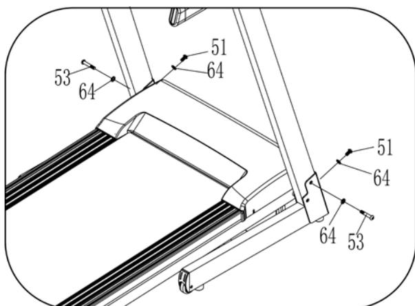
Зафиксируйте правую стойку консоли на основной раме болтами (53, 51) и шайбой (64).
